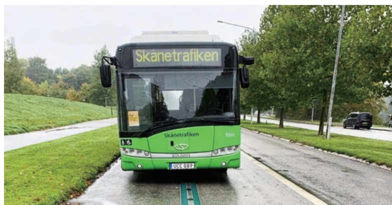
瑞典南部（斯科讷省）一段长约 21 公里的电动道路系统路段，可为电动公交车供电 来源：electrek.co
